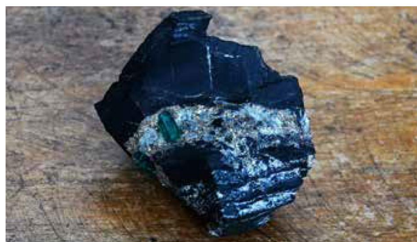
Foto 5. Voorbeeld van een handstuk (ongeveer 12 centimeter breed) met smaragd, gevonden in Chivor. Smaragd is hier gevonden precies in een plooi van zwarte schalie, waar de witte (calciet) ader in is gedrongen, met aan de randen veel pyriet (met messinggele metaalglans) en smaragd in het midden.
