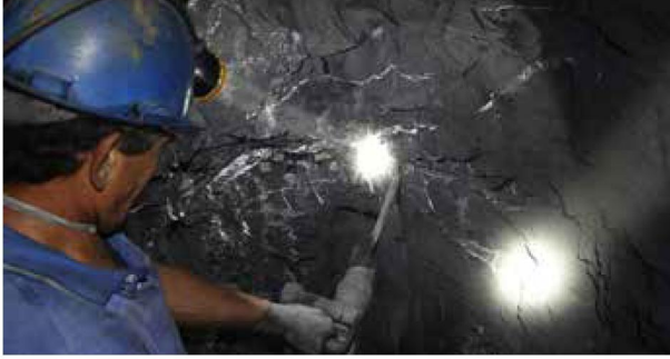
Foto 4. Witte en vaak heel dunne aders in zwarte schalies worden voorzichtig aangeboord, op zoek naar smaragd. Gecombineerd met plaatsen van dynamiet en gedoseerde explosies wordt stap voor stap doorgezocht.
