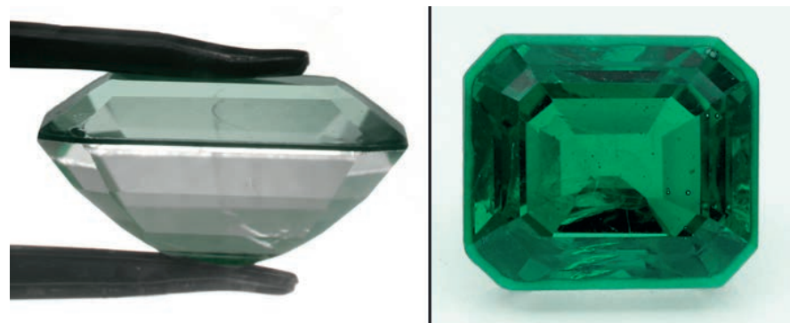
Zijaanzicht in water en vooraanzicht van een 'Soudé smaragd'. Luchtbellens zijn waarneembaar in de groene kitlaag (verdere uitleg zie tekst).
